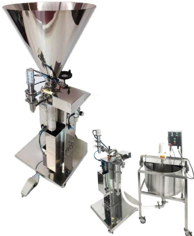
別置きタンクからの底抜き設定例
